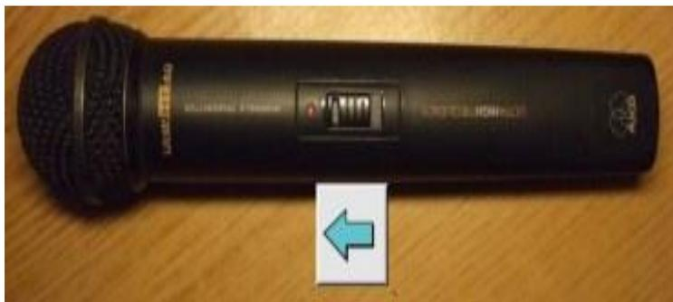
У микрофонов AKG индикатор включения красного цвета. Кратковременно загорается только в момент включения микрофона. О состоянии батареи можно судить по времени свечения индикатора – чем оно короче, тем лучше батарея. Если после включения индикатор светится
